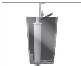
**i** L'efficacité du filtre s'épuise au bout de deux mois. Réglez sa durée de vie à l'aide du disque dateur placé sur le porte-filtre, dans le réservoir d'eau.
