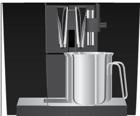
A lavagem do filtro para automaticamente após a circulação de aproximadamente 300 ml de água. O visor exibe “Seletor fechar”.
