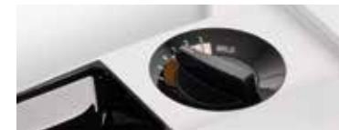
4. Réglez la finesse de la mouture en calibrant le broyeur de la machine. **Le bouton servant à ajuster le niveau de mouture ne doit être activé que lorsque le broyeur est en fonctionnement.** Le schéma ci-dessous vous indique le réglage de mouture à adopter en fonction de la couleur de torréfaction de vos grains de café.
